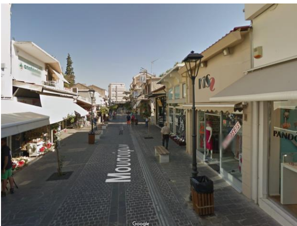
Εικόνα 5-24 Αντίστοιχη εικόνα προσβάσιμου δρόμου ήπιας κυκλοφορίας στην Παλιά πόλη Χανίων. Διακρίνεται η ισοσταθμία κίνησης πεζού και οχήματος που επιτρέπει την τοποθέτηση λωρίδας όδευσης τυφλών και την άνετη κίνηση αμαξιδίου.
