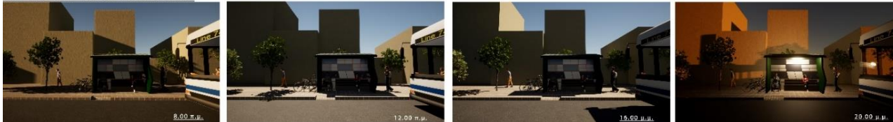
Εικόνα 5-13 Ανάλυση ηλιασμού και σκίασης κατά την πρόταση τοποθέτησης του σκέπαστρου ώστε να προσφέρει προστασία από την έκθεση σε καιρικές συνθήκες
