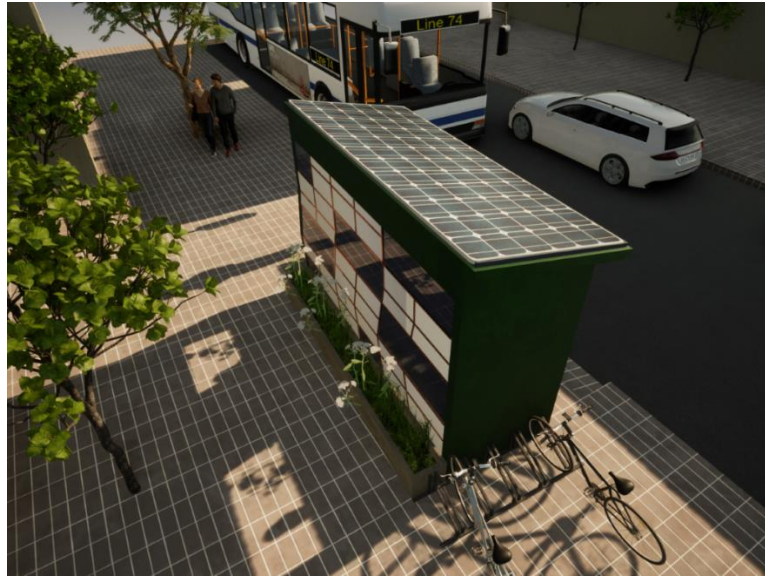
Εικόνα 5-12 Τρισδιάστατη απεικόνιση της πρότασης σκέπαστρου. Διακρίνεται η οροφή από φωτοβολταϊκά πάνελ
